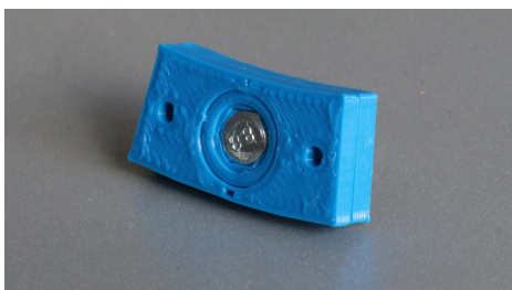
Figuur 4: Basisblokje met bout en opvulrand
